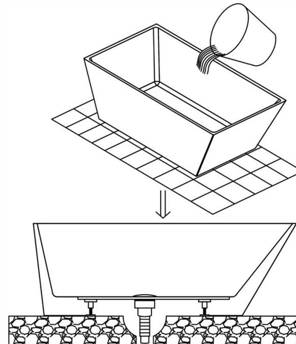
5. Trage eine dicke Schicht Silikon um die Wannenabflussleitung auf und lasse es 24 Stunden aushärten. Die Abfallentsorgung sollte von einem qualifizierten Handwerker durchgeführt werden.
