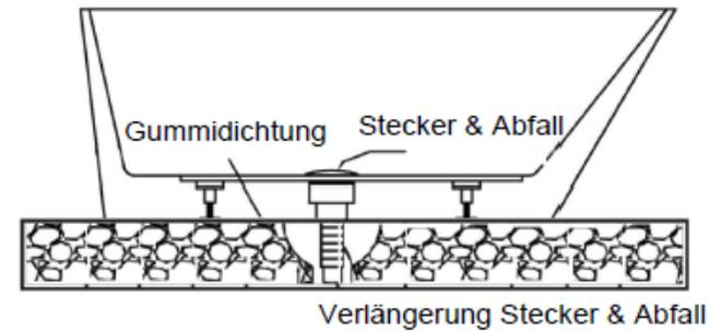
4. Zum Schluss muss noch ein Abschlusstest für die Entwässerung durchgeführt werden. Vergewissere dich, dass der dünne Kunststoff, der während der Montage an deinem Bad haftet, entfernt wurde. Fülle die freistehende Badewanne mit Wasser und vergewissere dich, dass das gesamte Wasser frei zum Abfluss fließt. Aufgrund der Oberflächenspannung kann sich eine geringe Menge Wasser ansammeln.
