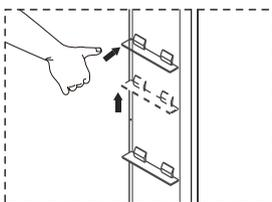
④ Die Halterung kann entsprechend den vorgebohrten Löchern im Inneren frei eingestellt werden.
