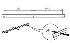
Messe den Abstand zwischen den 2 Markierungen. Nivelliere und markiere die Bohrlöcher an der Wand. Lege die Aluminiumhalterung zur Seite.
