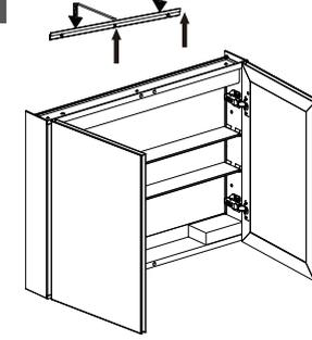
Bohre die Schrauben in diese Halterung, um den Schrank an der Wand zu befestigen.
