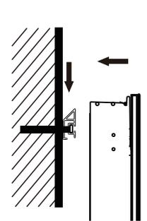
Hebe den Spiegelschrank mit zwei Personen auf. Stelle den Schrank an die Wand und schiebe den Spiegel nach unten, sodass die Aluminiumhalterung sicher in den oberen Rahmen des Schrankes gelangt.
