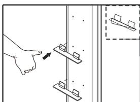
① Richte die Halterung mit den vorgebohrten Löchern im Inneren des Spiegelschranks aus, um die Stabilisierungshalterung zu installieren.
