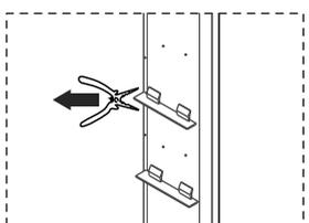
③ Du kannst eine Zange verwenden, um die Halterung zu entfernen.
