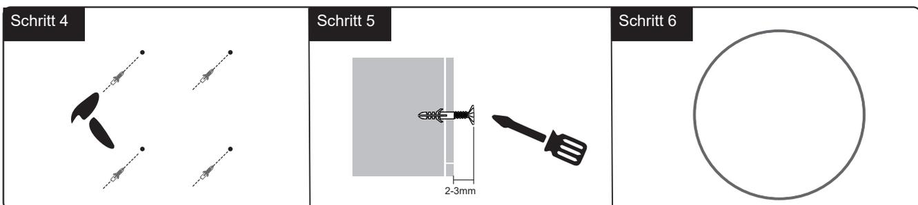
Schlage die Dübel mit einem Hammer in die Löcher.
