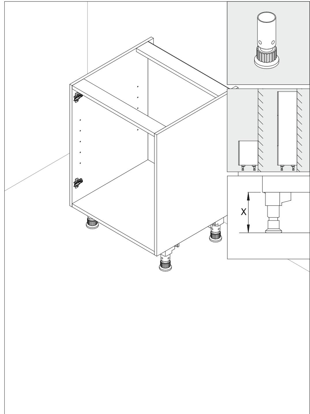
6. Ordne sie in der richtigen Reihenfolge an und richte sie mit einem Nivelliergerät aus (dies ist sehr wichtig).
