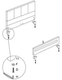
Schritt 2: Verschraube die vier Füße (11) am Kopf- und Fußteil (3) mit den Schrauben (16) und den Unterlegscheiben (23).
