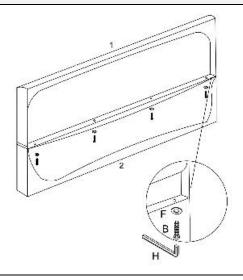
**Schritt 1:** Verschraube die beiden Kopfteile oben (1) und unten (2) mit den Schrauben (20) und den Unterlegscheiben (23).
