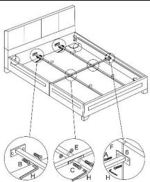
**Schritt 4:** Schraube beide Seitenteile an das Kopfteil mit den Schrauben (18), Federring (21) und den Unterlegscheiben (23). Schraube anschließend die Verstrebung (6) an die Seitenteile mit den Schrauben (17).
