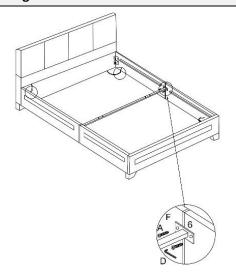
Schritt 4: Verschraube den Querstreben in der Mittelkante des Bettes. Nutze hierfür die Schraube (A).
