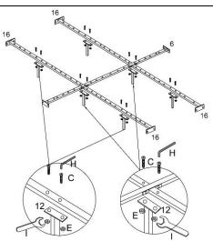
Schritt 5: Schraube die Stützen (12) an die Verstrebung 16 mithilfe der Schrauben (C) und ziehe sie fest.
