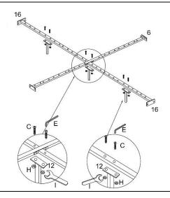
Schritt 5: Schraube die Stützen (12) an die Verstrebung 16 mithilfe der Schrauben (C) und der Muttern (H) und ziehe sie fest
