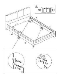
Schritt 3: Verschraube jeweils 2 Seitenteile (4/5) und die Metalauflage (8) mit den Schrauben (17) und den Unterlegscheiben (23).
