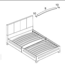
**Schritt 5:** Stecke die Federholzleisten in die Kunststoffkappen und stecke die in die Bohrungen an dem Seitenteil.
