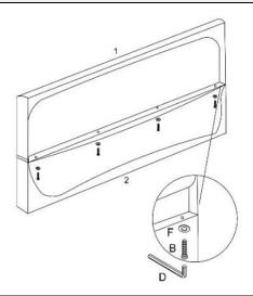
**Schritt 1:** Verschraube die beiden Kopfteile oben (1) und unten (2) mit den Schrauben (B) und den Unterlegscheiben (F).
