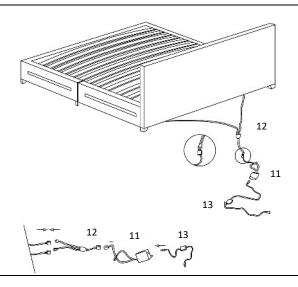
**Schritt 6:** Stecke die Verkabelung 12 und 11 zusammen stecke dann (11) und (13) zusammen Stecke danach (13) an (11) und (11) an (12)
