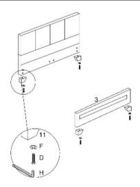
Schritt 2: Verschraube die vier Füße (11) am Kopf- und Fußteil (3) mit den Schrauben (D) und den Unterlegscheiben (F).
