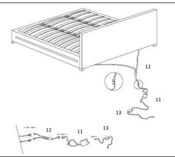
**Schritt 7:** Stecke die Verkabelung 12 und 11 zusammen stecke dann (11) und (13) zusammen Stecke danach (13) an (11) und (11) an (12).
