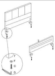
Schritt 2: Verschraube die vier Füße (7) am Kopfund Fußteil (3) mit den Schrauben (14) und den Unterlegscheiben (19).
