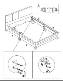
Schritt 3: Verschraube jeweils 2 Seitenteile (4/5) und die Metalauflage (8) mit den Schrauben (B), den Unterlegscheiben (F) und den Muttern (G).
