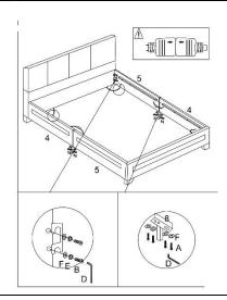
Schritt 3: Verschraube jeweils 2 Seitenteile (4/5) und die Metalauflage (8) mit den Schrauben (15) und den Unterlegscheiben (19).
