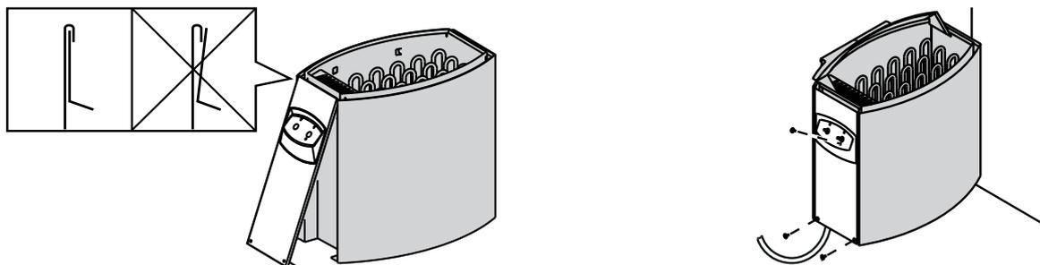
Abdeckung montieren und demontieren
