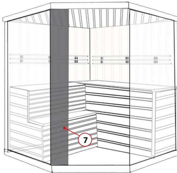
**Schritt 14: Montage der Glasscheibe rechts klein und der Glastür**
