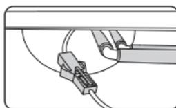
Stecke den Luftschlauch (1) und das Gleichstromkabel (2) in die Schlitz. Befestige es nach dem Anschließen mit Kalbelbindern und decke das ganze mit einem Nylontuch ab.
