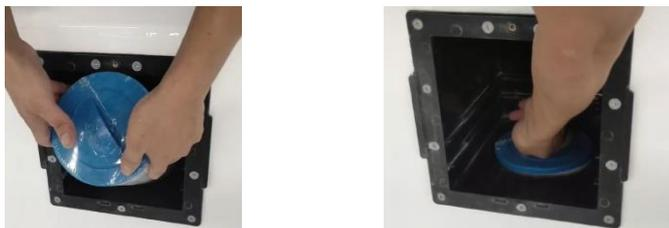
Setze die beiden Verkleidungen ein und schliesse das Filtergehäuse.
