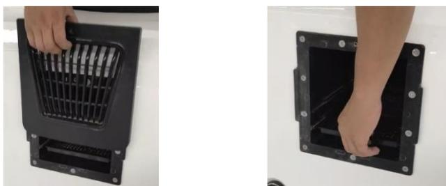
Löse die Kartusche durch leichte Drehbewegungen und entnehme diese aus dem Filtergehäuse.
