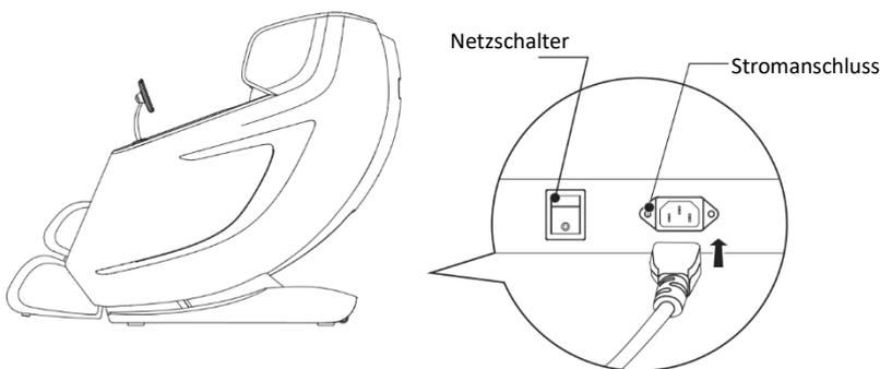
Stecke das Netzkabel in die Anschlussbuchse des Produkts und schalte das Produkt ein.
