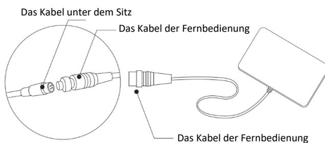
Verbinde den Stecker mit der Buchse des Heizdrahtes.
