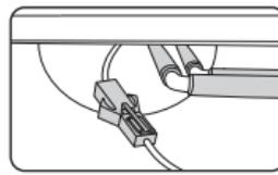
Stecke den Luftschlauch (1) und das Gleichstromkabel (2) in die Schlitze. Befestige es nach dem Anschließen mit Kalbelbindern und decke das ganze mit einem Nylontuch ab.
