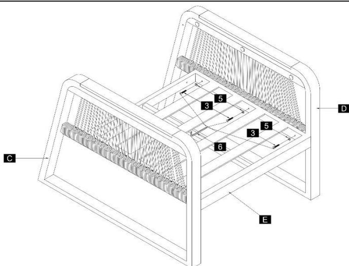
**Schritt 2:** Montiere die Armlehne rechts (C), Armlehne links (D), Sitzfläche (E) mit den Schrauben (3) und U-Scheiben (5).
