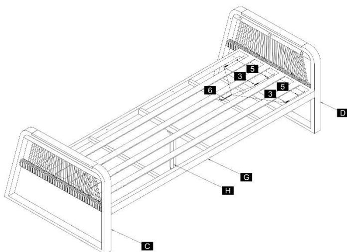
**Schritt 3:** Montiere die Armlehne links (D) ebenfalls an die Sitzfläche (G) mit den Schrauben (3) und U-Scheiben (5).
