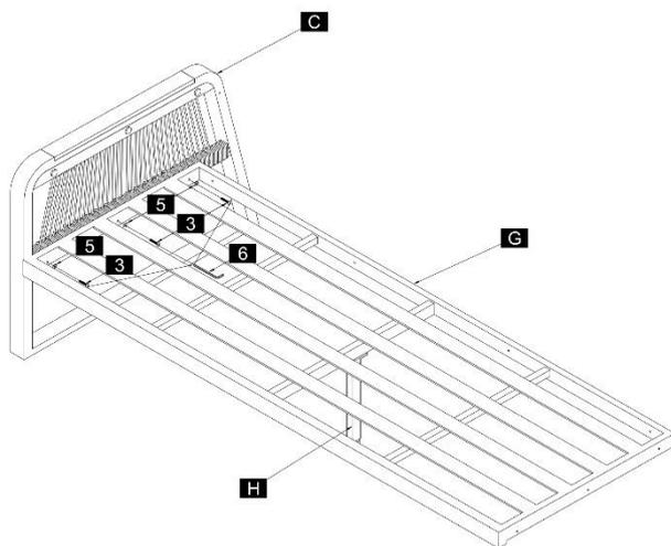
**Schritt 2:** Montiere die Armlehne rechts (C), Sitzfläche (G) mit den Schrauben (3) und U-Scheiben (5).
