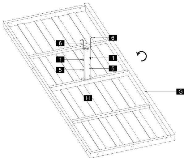
**Schritt 1:** Montiere den Mittelfuß (H) mit den Schrauben (1) und U-Scheiben (5) unterhalb der Sitzfläche (G).
