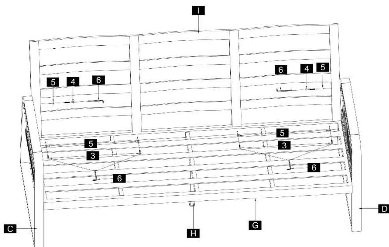
**Schritt 4:** Montiere die Rückenlehne (1) mit den Schrauben (4) und U-Scheiben (5).
