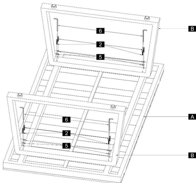
**Schritt 1:** Platziere die beiden Gestelle **(B)** auf die untere Tischplatte **(A)**. Schraube sie mit den Schrauben **(2)** und den U-Scheiben **(5)** fest.
