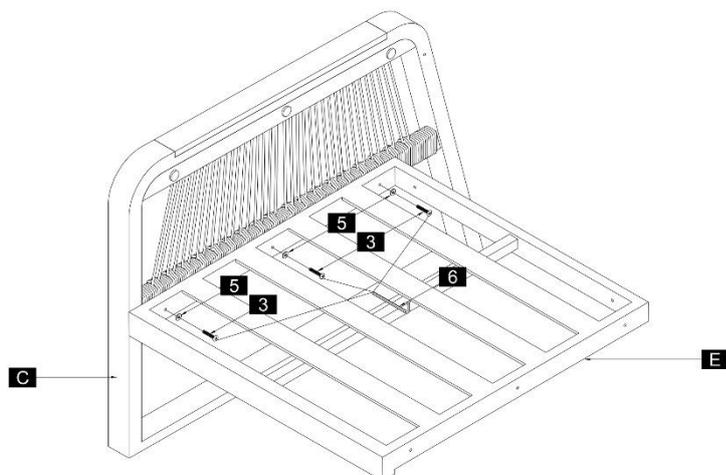
**Schritt 1:** Montiere die Armlehne rechts **(C)**, Sitzfläche **(E)** und den Mittelfuß (H) mit den Schrauben **(3)** und U-Scheiben **(5)**.
