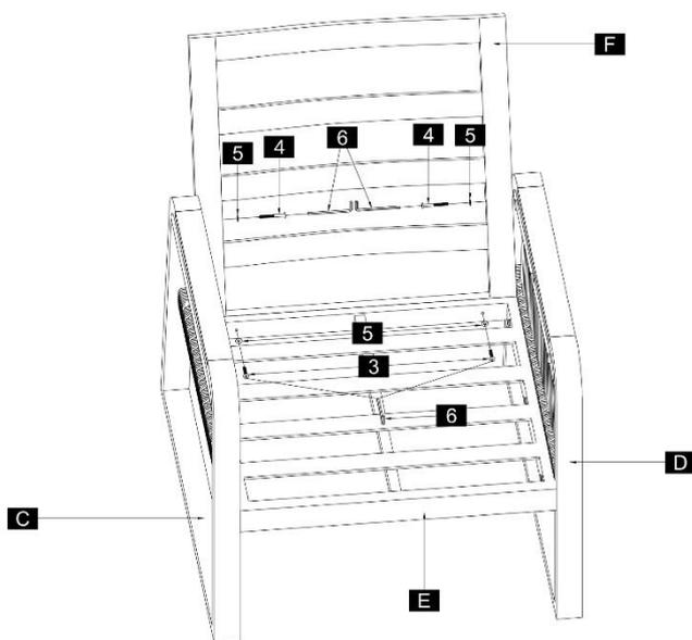
**Schritt 3:** Montiere die Sitzfläche (E) mit den Schrauben Schrauben (4) und U-Scheiben (5).
