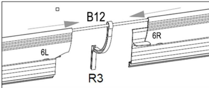
*6L und 6R lassen sich leichter installieren, wenn Sie Schmierstoff verwenden.*
